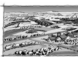
II. TERÜLETI KATEGÓRIA - ALACSONY VEGETÁCIÓJÚ TERÜLETEK, PL. FŰ ÉS NÉHÁNY TEREPAKADÁLY (FA, ÉPÜLET), AHOL AZ ÉPÜLET-AKADÁLY TÁVOLSÁG AZ AKADÁLY MAGASSÁGÁNAK min. A 20-SZOROSA
