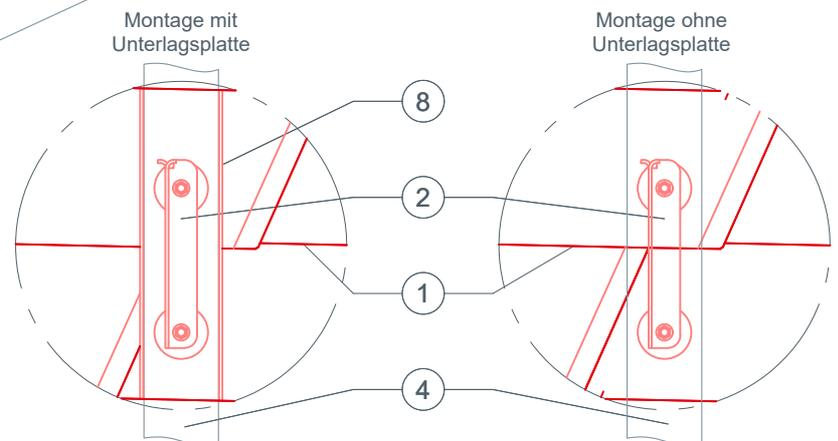
Bei kleinformatigen Dachelementen kann es erforderlich sein, eine Unterlagsplatte einzubauen, um das Schneerechensystem zu montieren (z. B. wenn ein Falz im Montagebereich über dem Sparren liegt).
