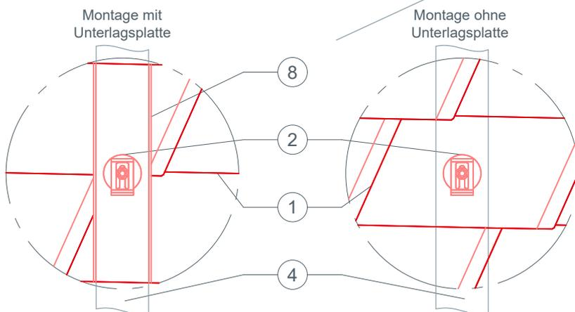
Bei kleinformatigen Dachelementen kann es erforderlich sein, eine Unterlagsplatte einzubauen, um den Solarhalter Vario oder Fix zu montieren (z. B. wenn ein Falz im Montagebereich über dem Sparren liegt).
