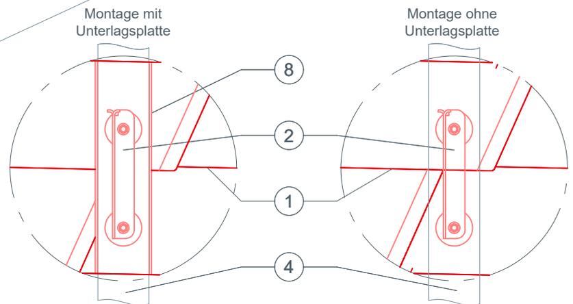
Bei kleinformatigen Dachelementen kann es erforderlich sein, eine Unterlagsplatte einzubauen, um die Gebirgsschneefangstütze zu montieren (z. B. wenn ein Falz im Montagebereich über dem Sparren liegt).
