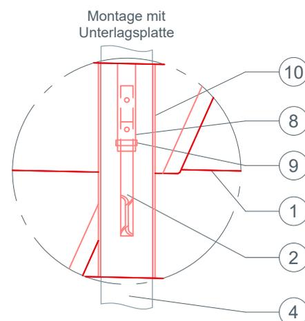
Bei kleinformatigen Dachelementen kann es erforderlich sein, eine Unterlagsplatte einzubauen, um den Sicherheitsdachhaken zu montieren (z. B. wenn ein Falz im Montagebereich über dem Sparren liegt).
