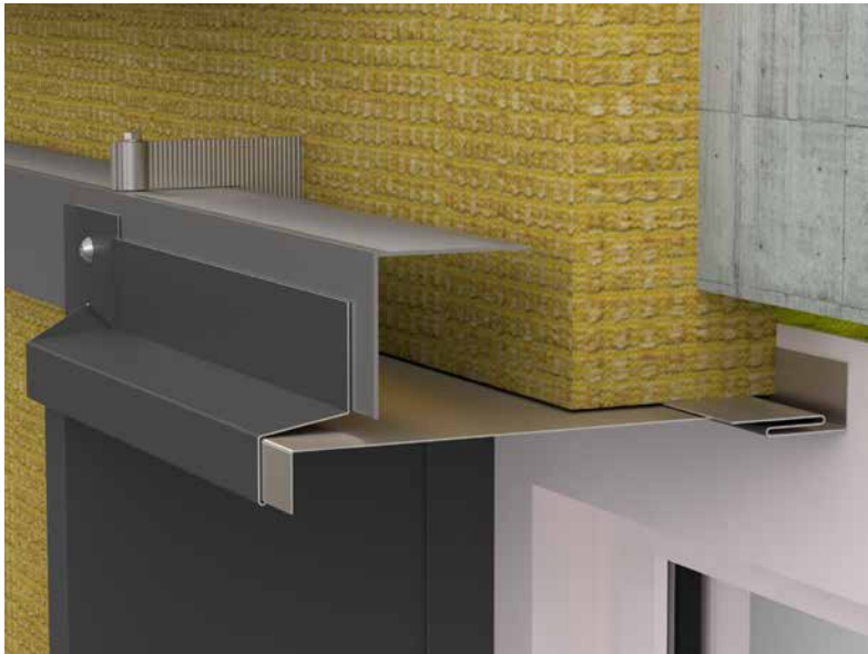
101. ábra • Szerelés párkánylemez ablaktok
