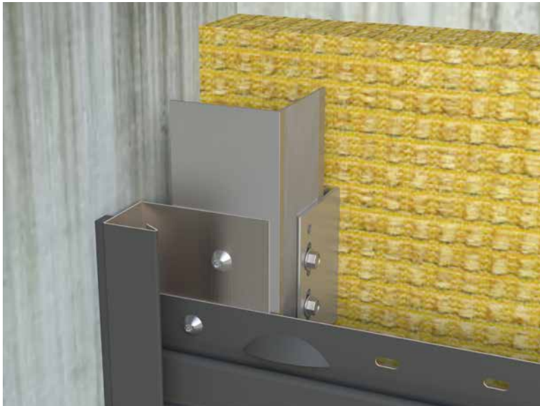
85. ábra • Oldalsó csatlakozás
