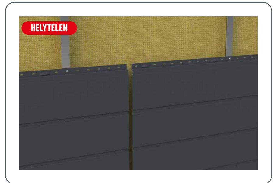
92. ábra • A nyitott illesztési hézagok használata TILOS
