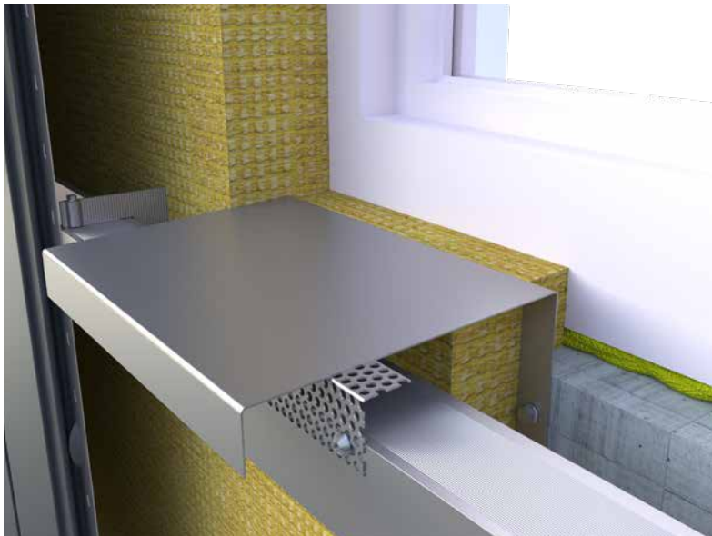
93. ábra • Perforált lemez és tartószegély felszerelése
