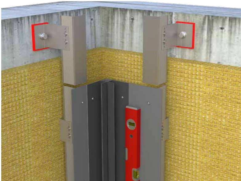
82. ábra • Belső sarok, vízszintes Siding
